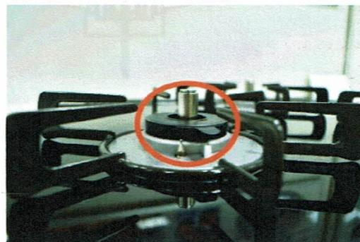
ガスこんろは2008年10月以降、全口過熱防止センサーの搭載が義務化され、白い煙が出始める250℃で自動消火されます。
